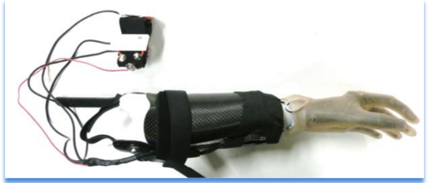
筋肉表面の電位によって制御できる「筋電義手」*
