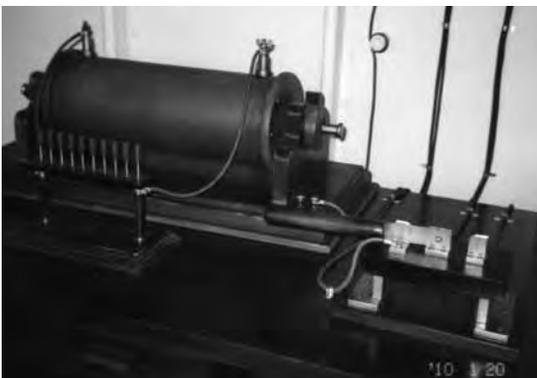
⑦NHK製作の三六式無線電信機・感应線輪と火花放電端子
